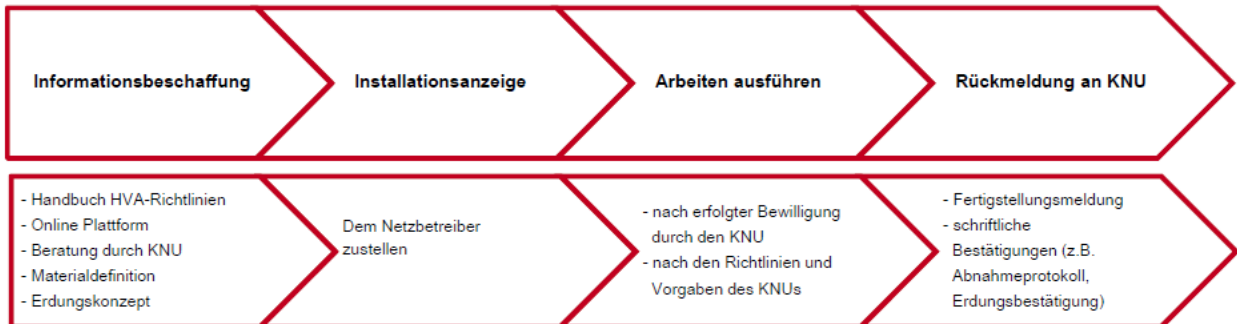
Abbildung 3: Ablauf Planer & Installateur (Quelle: SUISSDIGITAL)
