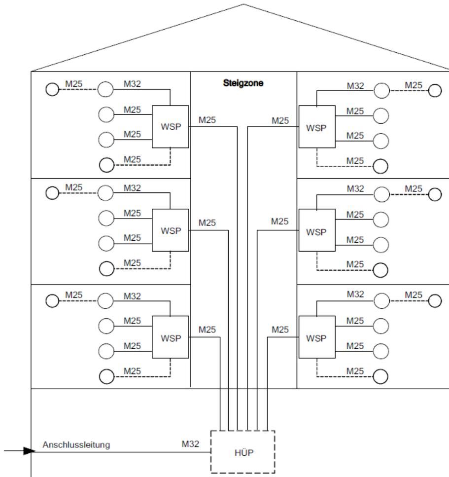
Abbildung 5: Zukunftsorientierte Rohrverteilanlage mit Wohnungsternpunkt (Quelle: SUISSDIGITAL)
